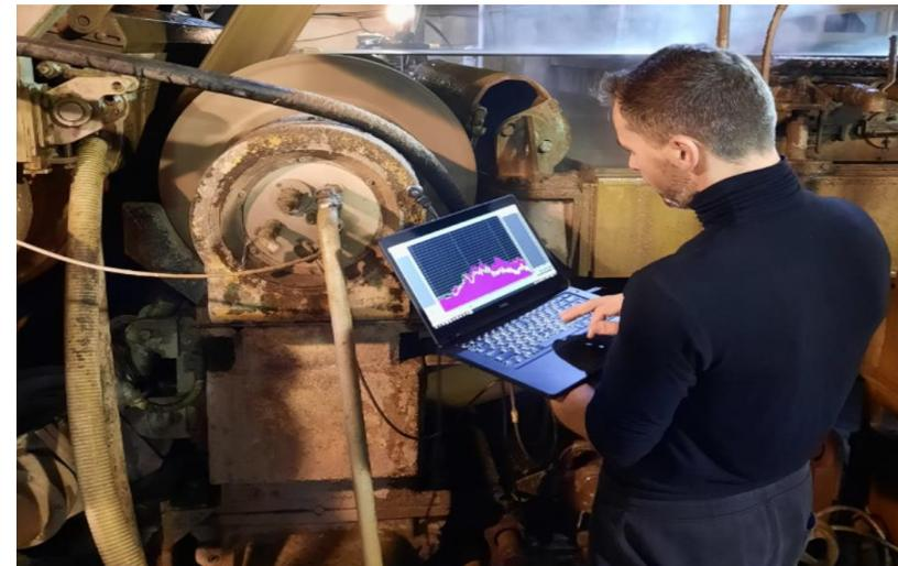
*Процесс снятия «слепок» АЧХ*
