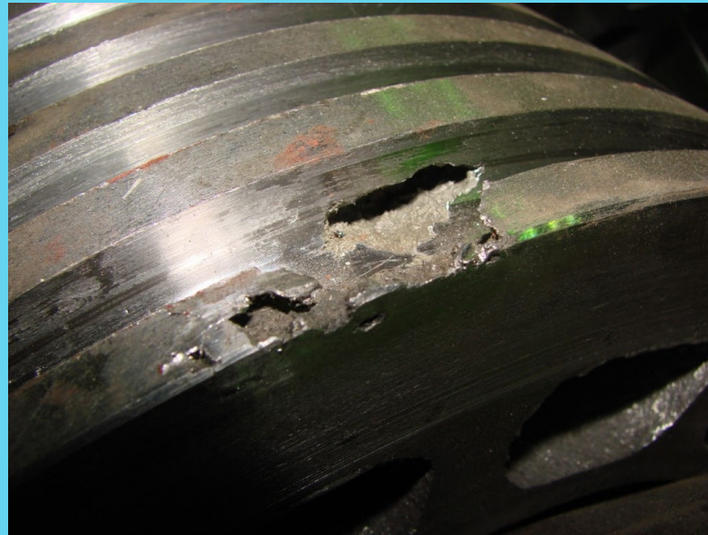
Низкое качество обработки и повреждение заготовки
