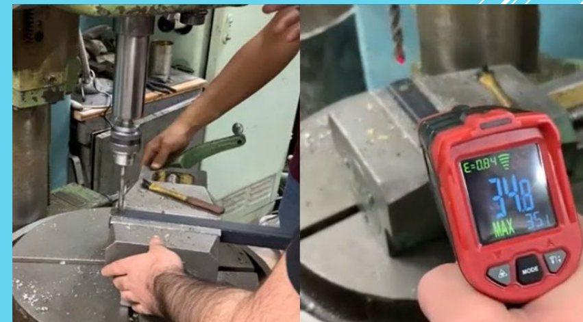
Исследование температурных значений
