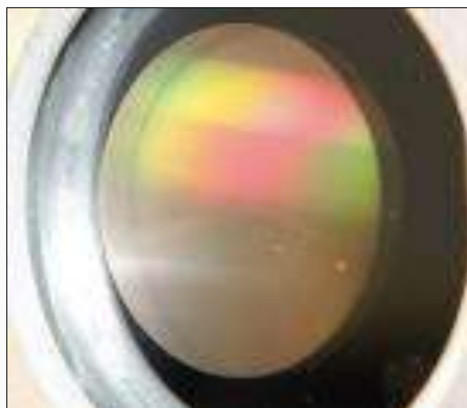
дифракционная решетка с переменной высотой штрихов
